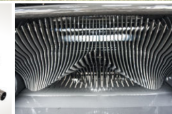
XtraCut25 rotor - Szeletelőszerkezet : akár 25 kés
