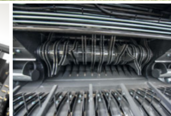
XtraCut13 rotor (ujjpár távolság: 90 mm) - Szeletelőszerkezet nélkül (sorozat) - Szeletelőszerkezet : akár 13 kés
